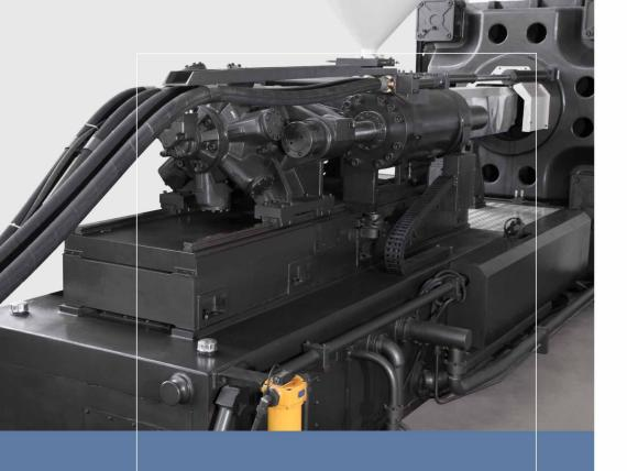
射臺滑座機構是T型槽壹體化設計, 令滑行更穩定。
